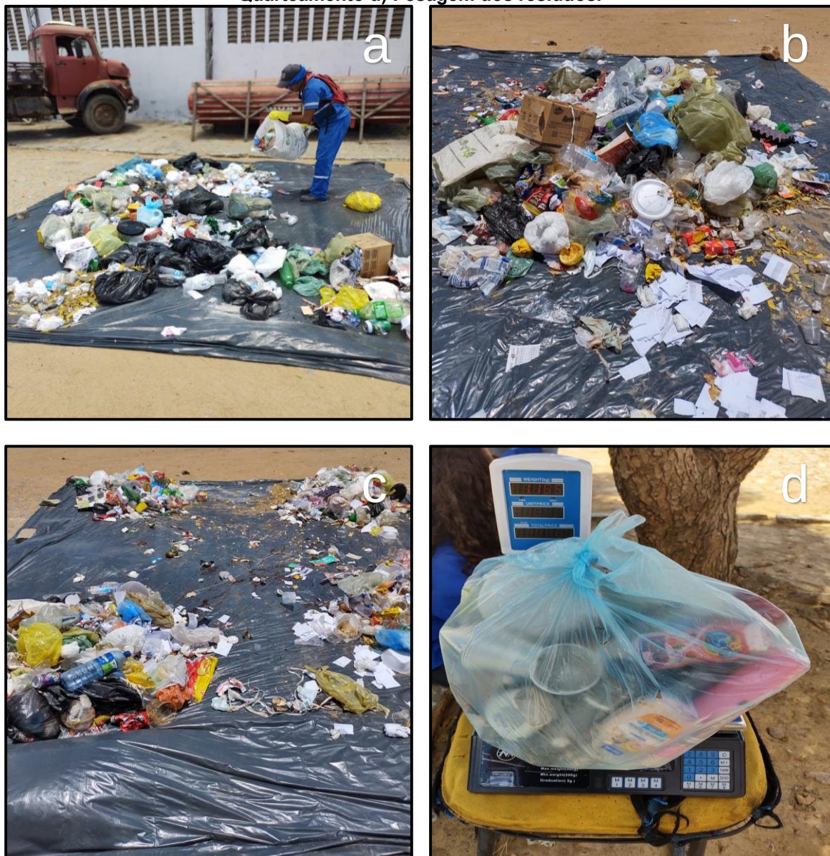
Figura 13 – Procedimentos para amostragem dos resíduos sólidos do município de Quixadá. a) Despejo dos resíduos sobre lona plástica b) Mistura dos resíduos c) Realização do primeiro Quarteamento d) Pesagem dos resíduos.
